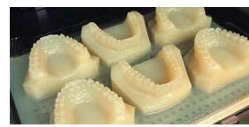
SLA (Stereolithography): Piezak geruzaz geruza sortzen ditu, fotopolimero likidoko erretxinak solidotzen dituen laser ultramore baten bidez.
