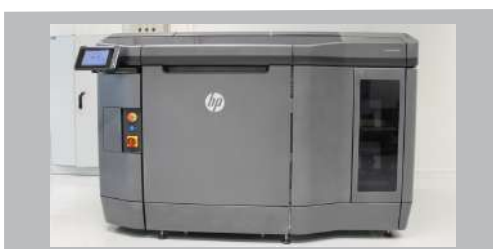
HP Multi Jet Fusión: Adizio bidez, agente askotako inprimaketa-prozesu batean, piezak fabrikatzeko manufaktura gehigarriko metodo bat da.
