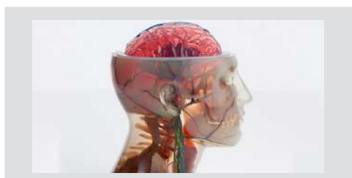
Polyjet: Material Fotopolimerikoak birrintzean datza, eraikitze plataforma baten gainean, ondoren UV argiarekin landuz.
