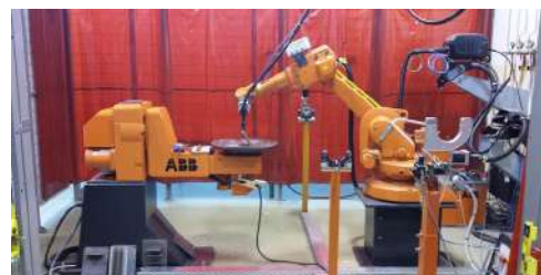
WAAM (Wire+Arc Additive Manufacturing): Soldaduraren antzeko teknologia horrek arku elektrikoa erabiltzen du, metalezko hari bat gainazalean zuzenean urteko.
