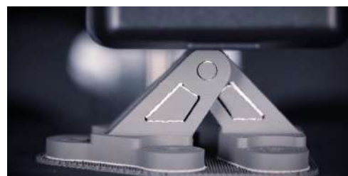
Binder Jetting: Fabrikazio gehigarriko metodo bat da, agente aglutinatzaile bat gehituz piezak sortzen dituena.
