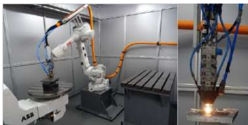
LMD (Laser Metal Deposition): Substratu baten azalean injektatutako metal-hauts bat zuzenean urteza, oinarritzko materialaren propietate berak edo hobekak dituzten estaldurak eta/edo egiturak lortzeko.
